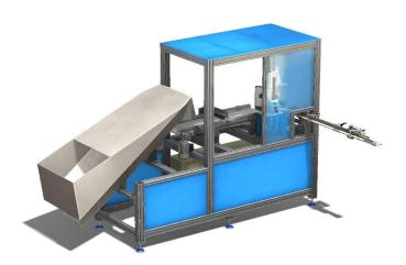
Alimentatore automatico di ghiere con Robot  $\,$  e sistema di visione a doppia telecamera .
