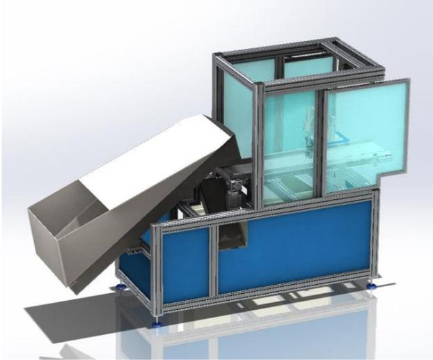
Caricatore automatico di manici con Robot e sistema di visione. Tramoggia di carico in acciaio inox da 200 Lt. Produttività oraria 1500 pezzi. Possibilità di assistenza in remoto.
